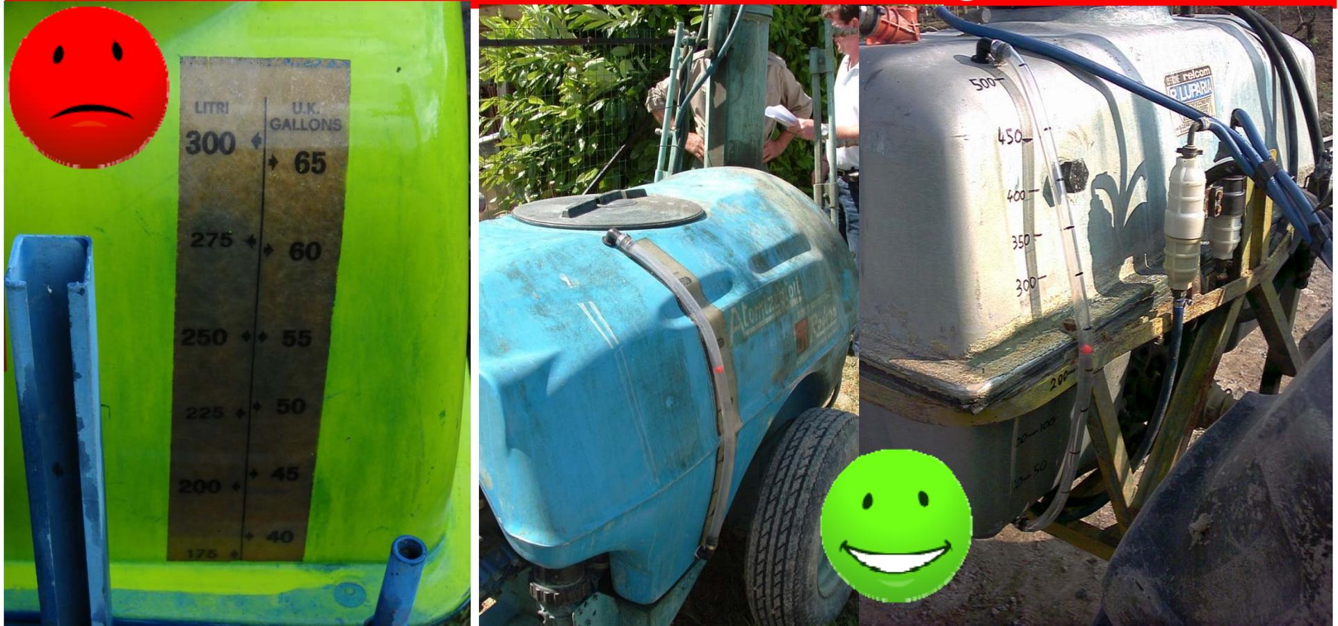
Deve essere **SEMPRE** presente **almeno un indicatore del livello di liquido** del serbatoio **chiaramente leggibile e visibile** sia dal posto di guida che dalla postazione di riempimento.
